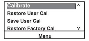
**3.** With **Calibrate** highlighted, press display:
